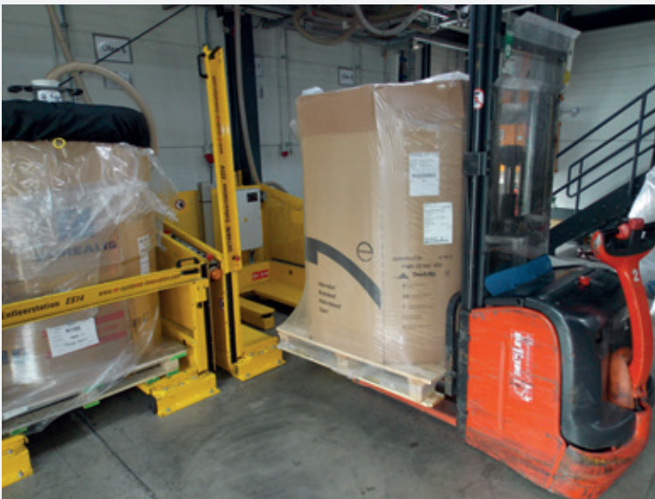
Abb. zeigt Oktabin Entleerstation mit Zubehör "Erhöhungsrahmen"
